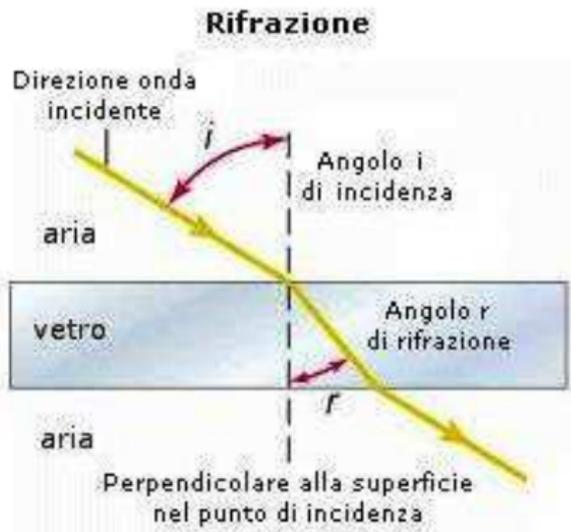
Indice di rifrazione di un materiale:  $n = \frac{c}{v}$ , dove  $c$  è la velocità della luce nel vuoto mentre  $v$  è la velocità della luce nel materiale.
